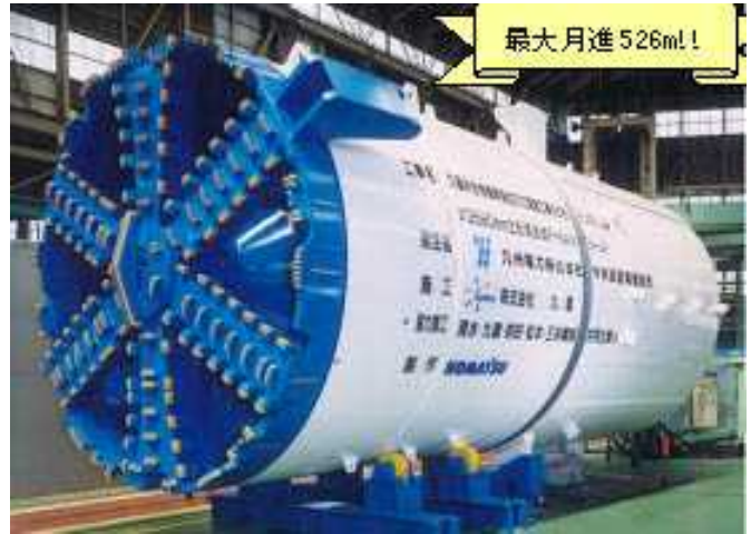
<F-NAVIシールド> 3590mm泥土圧式シールド 最大月進526m!!
