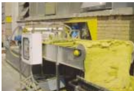
オーバースプレー塗装回収装置
