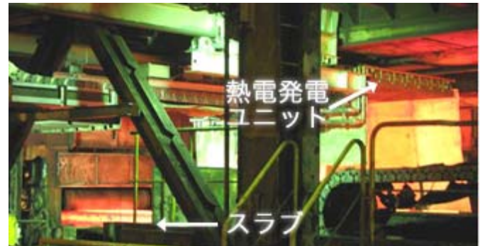
●● 連続鋳造機での実証試験例 (JFEスチール(株)殿ご提供)
